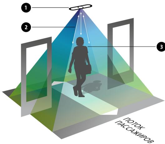
1 Датчик IRMA (передатчик + приемник)
